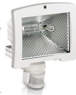
Lorsqu'une personne arrive dans le champ déterminé, le détecteur de mouvement détecte son arrivée. Un détecteur de lumière mesure en permanence la luminosité du champ déterminé. Les 2 informations sont alors transmises à une carte électronique, qui enclenche l'allumage de l'éclairage grâce à un relais électrique et des fils électriques branchés sur le réseau EDF.
