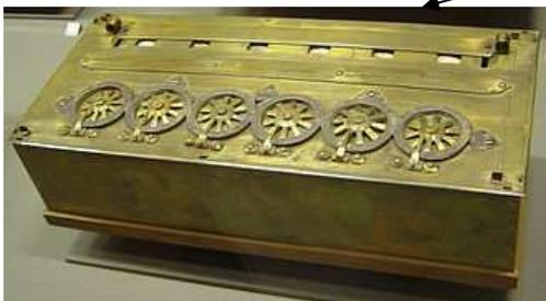
Le philosophe et mathématicien français Pascal (1623-1662) présente à Paris sa Pascaline, machine à additionner et à soustraire qui fait appel à un mécanisme d'horlogerie: huit roues de neuf dents. La première roue tourne de neuf crans puis elle reprend sa position initiale pendant que la seconde roue avance d'un cran à la fois et ainsi de suite. On pouvait y entrer deux nombres à la fois en bougeant des roues avec un
